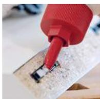
Se alla giunzione viene aggiunta colla, si aumenta del 30% la resistenza alla trazione
