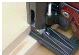
«Protezione fresatura scorrevole trasparente per riparazioni nelle piegature»
